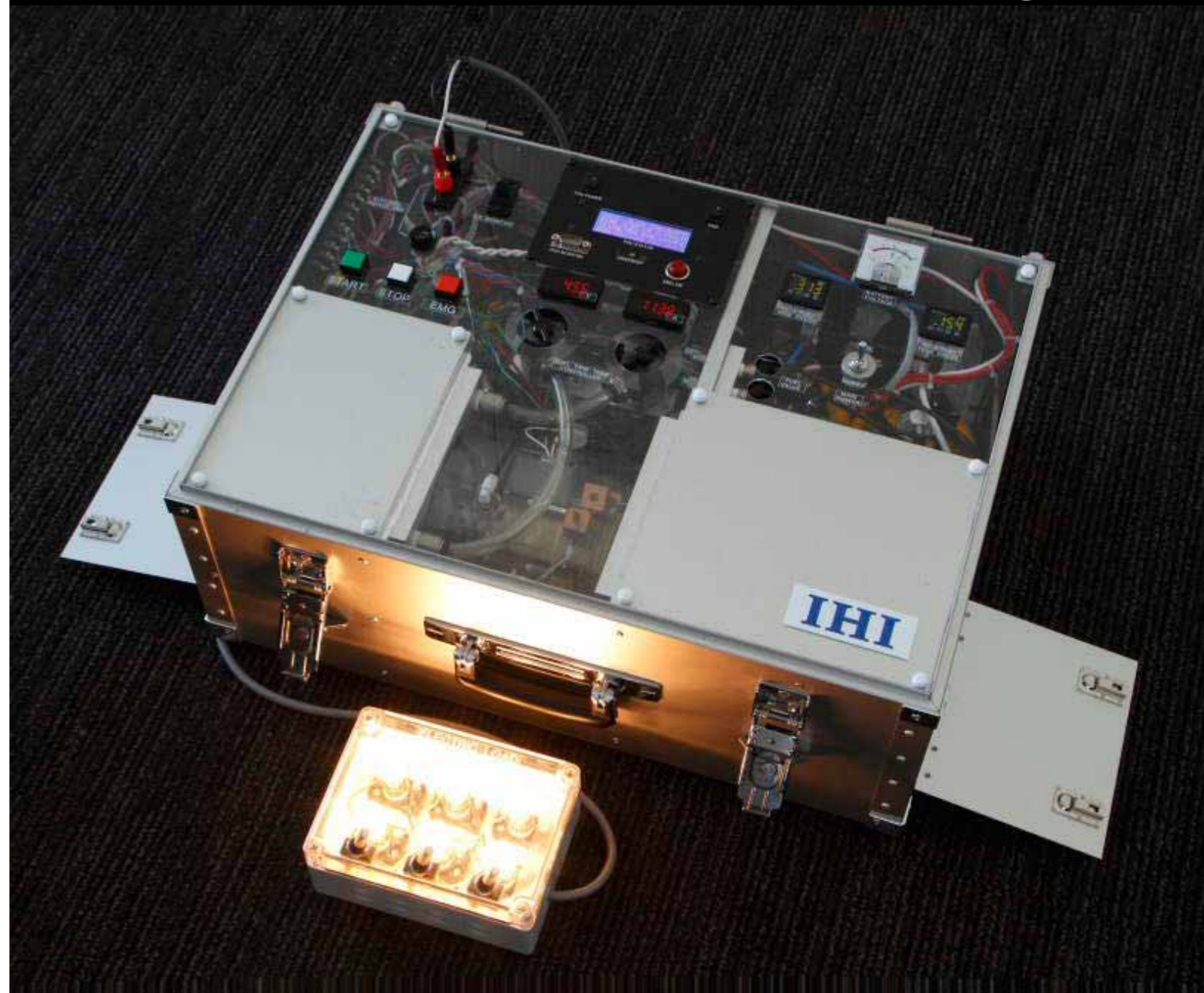
機殼右上為燃料供給部，左上為控制部。中央放著發動機，右側為排氣口與消音器，左側則有另一個消音器。機殼總重13公斤，若使其輕量化，便可將體積減半，重量則可減輕至8公斤。
