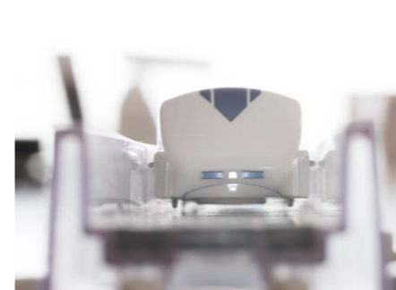
磁石の力でレールの上を約2mm浮上。車輪や回転モーターといった駆動装置はない。
