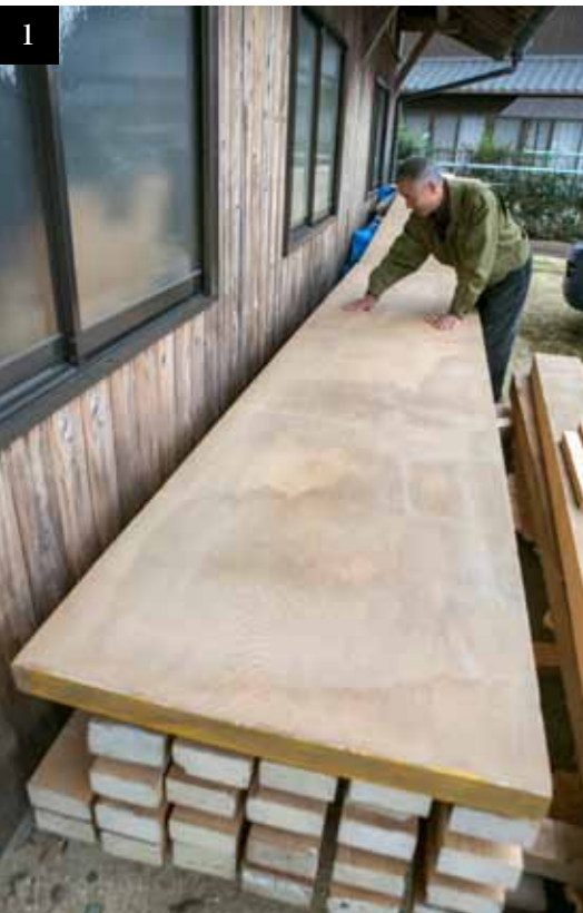
1 製作する桶の形や使うが決まると、材料となる材木を吟味して選び出す。古代檜(紅檜)の板材は通常、幅60cm、長さ4m。
