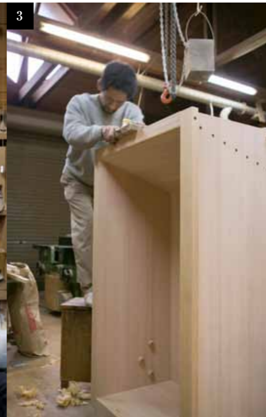
3 組立ててからも、かながけ、面取り、最終磨きをする。目で見て美しく、木肌のなめらかさが伝わるように仕上げる。
