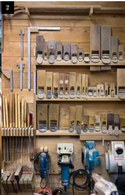
2 浴槽の形に応じて使う、かなややすりが並ぶ道具置き場。大小様々な道具を使い分けて、微妙な曲線や角度を出す。
