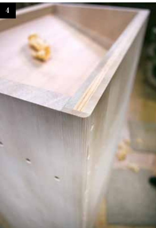
4 側板の厚みは33～40ミリ。側板の幅があると高級に見えるが、品質には影響しない。底板は厚さがあるほど丈夫になる。
