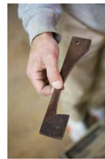
丸形の浴槽を作るとき使う、専用の定規。
