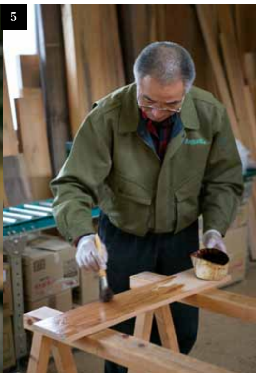
5 漆仕上げにも応じる。木の呼吸を妨げず、抗菌作用に影響を与えない漆を選び、部材一つずつに、一日に一層ずつ塗り重ねる。
