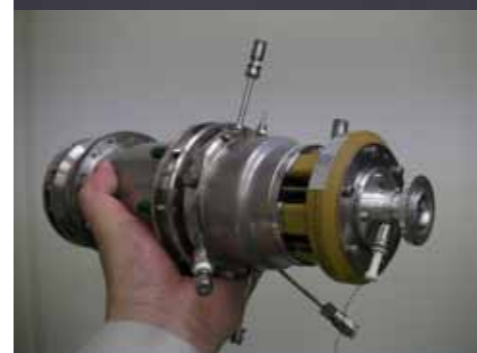
手の平サイズのガスタービン本体。400Wの出力を実現。回転数は40万rpm。燃料はプロパンの他、軽油、灯油で実証済み。理論的にはバイオ燃料も使える。左の写真は熱交換機を付けたもの。これにより、熱効率をガソリンエンジンと同等まで引き上げることが可能。
