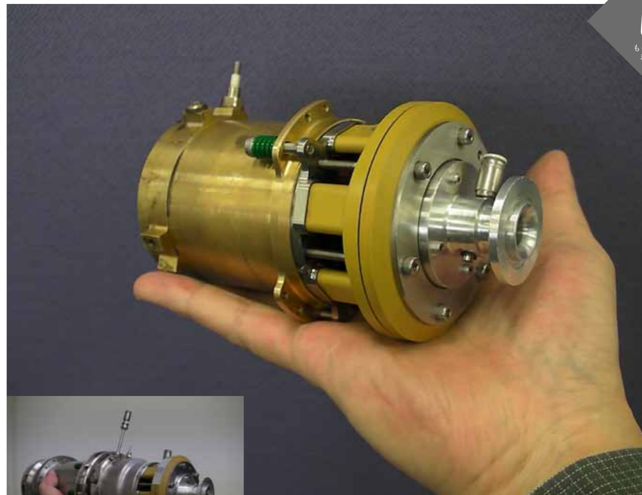
手の平サイズのガスタービン本体。400Wの出力を実現。回転数は40万rpm。燃料はプロパンの他、軽油、灯油で実証済み。理論的にはバイオ燃料も使える。左の写真は熱交換機を付けたもの。これにより、熱効率をガソリンエンジンと同等まで引き上げることが可能。
