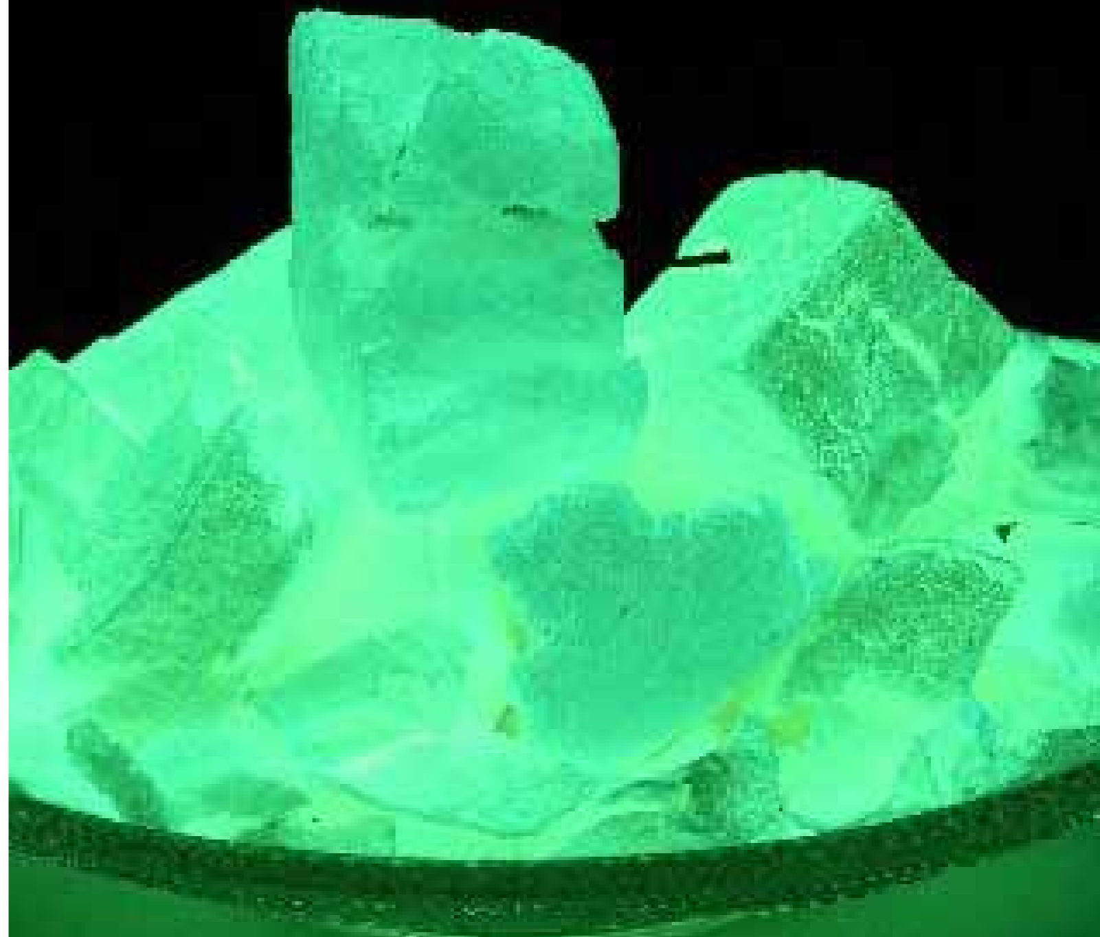
原料となる粉末を調合し、焼成して作られたN 夜光。このブロックを粉末状にしたものが製品として出荷される。
