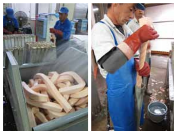
つくば工場と海外(中国とタイ)の2工場で毎月1500万個以上のスポンジを生産。泡立てた材料を型に流して蒸し上げ、両手でねじあげながら型から取り出す。柔らかい素材のため、機械は使えず手作業になる。
