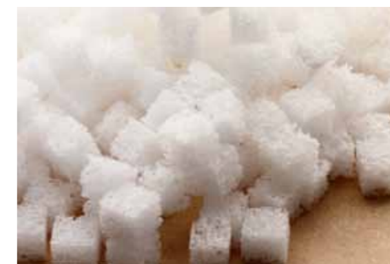
1cm角の素材 PVA。抜群の吸水・保水力があり、耐摩性能にも優れている。隙間に微生物を住まわせることで水質浄化ができると考え、現在検証中だ。
