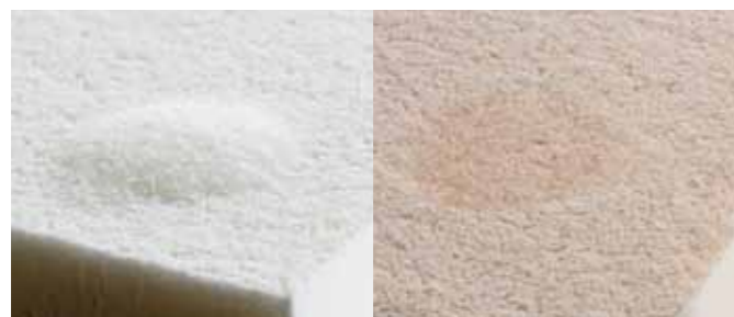
1970年代は、油を吸収したスポンジはその部分が膨張してしまった(写真左)。ユキロンは油分を含んでも膨張しない(写真右)。
