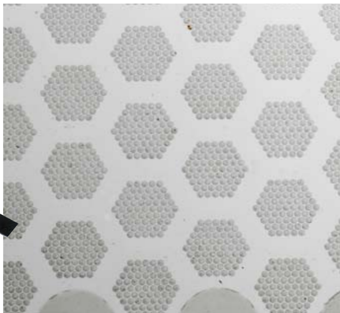
クマクラの基盤技術となる微細加工のサンプル。上、タングステンの中央には100ミクロンの穴が整然と並んでいる。右、超音波によって、希望する素材に模様を描いたり、精巧に穴をあけたりすることができるという例。各種光学ガラスやファインセラミックス、石英ガラスなどにも同様の加工が可能だ。
