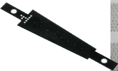
クマクラの基盤技術となる微細加工のサンプル。上、タングステンの中央には100ミクロンの穴が整然と並んでいる。右、超音波によって、希望する素材に模様を描いたり、精巧に穴をあけたりすることができるという例。各種光学ガラスやファインセラミックス、石英ガラスなどにも同様の加工が可能だ。
