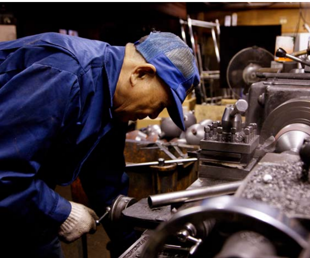
砲丸づくりは1台の機械で行なわれていた。手や耳から感じ取る感覚を頼りに削っているときは、砲丸を見ることはほとんどない(写真左)。鋳物屋から届けられたボス(耳のような部分)付きの砲丸の原型は、辻谷さんの手によって14工程を経、中心に重心のある砲丸へと変貌していく。この工程の中で動を働かせて切削し、突切りバイトでボスを切り落として完成(写真右上)。工具や治具がびっしりと並べられた棚(写真右下)。
