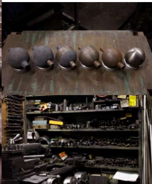
砲丸づくりは1台の機械で行なわれていた。手や耳から感じ取る感覚を頼りに削っているときは、砲丸を見ることはほとんどない(写真左)。鋳物屋から届けられたボス(耳のような部分)付きの砲丸の原型は、辻谷さんの手によって14工程を経、中心に重心のある砲丸へと変貌していく。この工程の中で動を働かせて切削し、突切りバイトでボスを切り落として完成(写真右上)。工具や治具がびっしりと並べられた棚(写真右下)。
