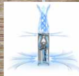
搭载双风扇，从上方开口每分钟可排出最大 1 万公升的空气，兼具循环机的功能。
